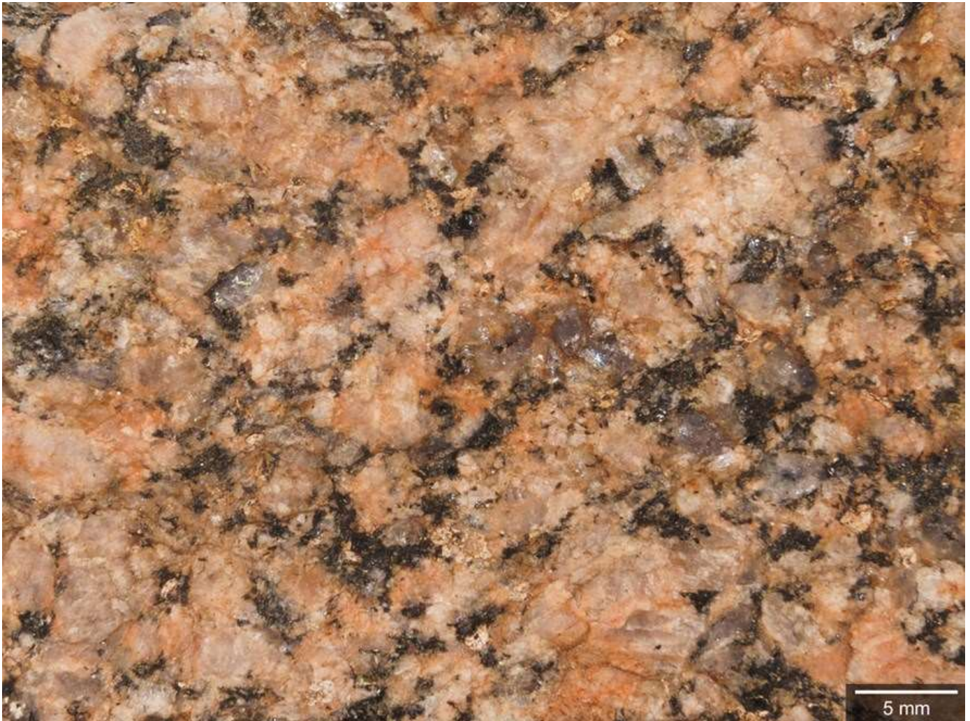
Abb. 3: Der Granit-Findling besteht überwiegend aus rötlichem Alkalifeldspat, grauen Quarzkörnern und schwarzen Biotitschüppchen. Weißlicher Plagioklas tritt nur untergeordnet auf. (Foto: Marc Torbohm).
