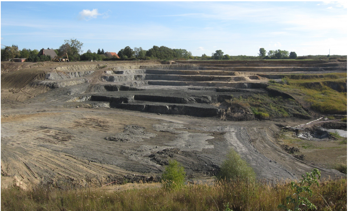
Abb. 1: Blick vom Grubenrand auf die Abbaustöße, Situation am 16.09.2018. Die beiden untersten Abbaustöße (dunkel) erschließen den Eozänthon, darüber sind eine dicke Geschiebemergeldecke und Sandschichten sichtbar.
