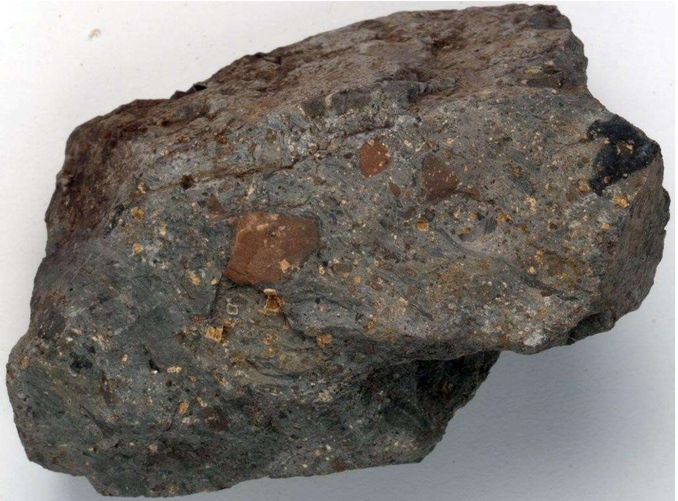
Abb. 15: Oppkuven-Ignimbrit aus dem westlichen Teil des Anstehenden. In der Verwitterung zeigt sich die Grundmasse grün-grau. Anstehendgestein, 12x9 cm, leg. Arildskov.
