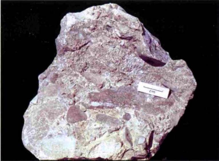
**Abb. 4** Geschiebe des grauen postsilurischen Konglomerats mit einem 9 cm großen kalkigen Schiefergeröll, chaotischem Gefüge und graugelblichem Bindemittel, Kap Arkona, Teilstück (leg., fot. Verf.).
