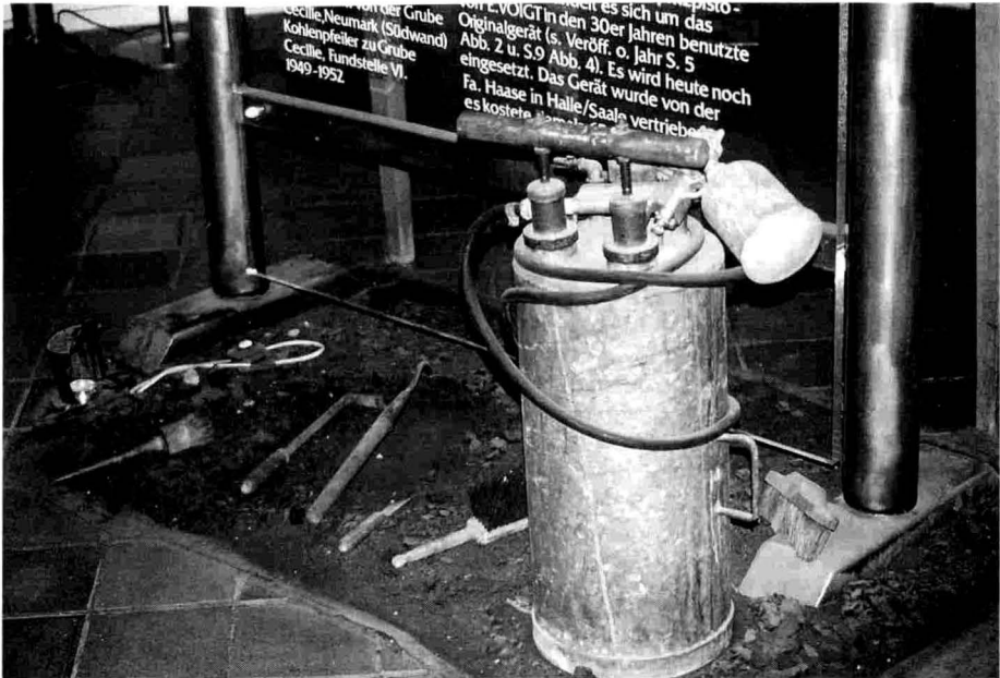
Abb. Spritzluftkessel und Spritzpistole für die Herstellung von Lackfilmen, genutzt von Prof. E. VOIGT. Geiseltalmuseum Halle/Saale. Foto: K.KRAUSE.
